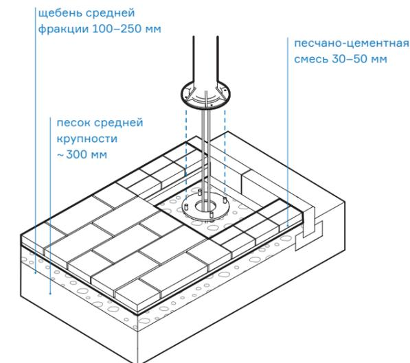
Выполнить мощение тротуара в соответствии с проектом. Установить стойку фонаря на опоре основания и провести через эту стойку электрокабель.
