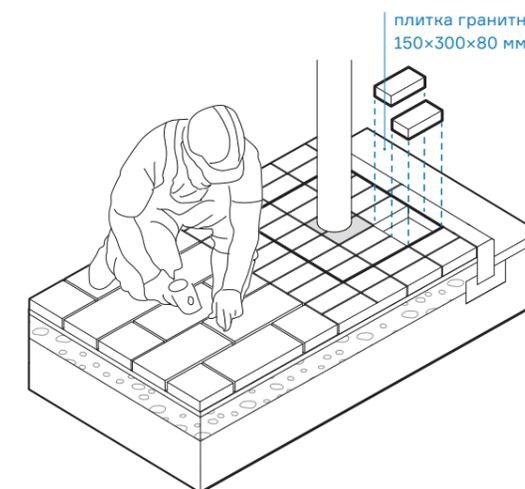
Вокруг опоры фонаря подготовить основание под плитку и уложить плиты мощения. Обрезать те из них, что примыкают к стойке фонаря.
