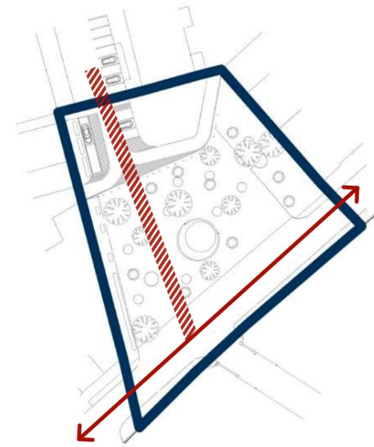
**СХЕМА размещения зоны проезда спец-транспорта:**
