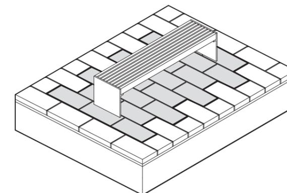
Выполнить мощение. Обрезать плиты, примыкающие к опорам скамьи. После укладки мощения во всех зонах тротуара полить его водой.
