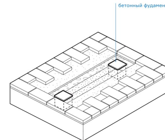
В слое песка обустроить столбчатые фундаменты высотой 500 мм под ножки скамьи. В местах, где проложены инженерные коммуникации, возможна установка бетонной плиты толщиной 300 мм под всю скамью.
